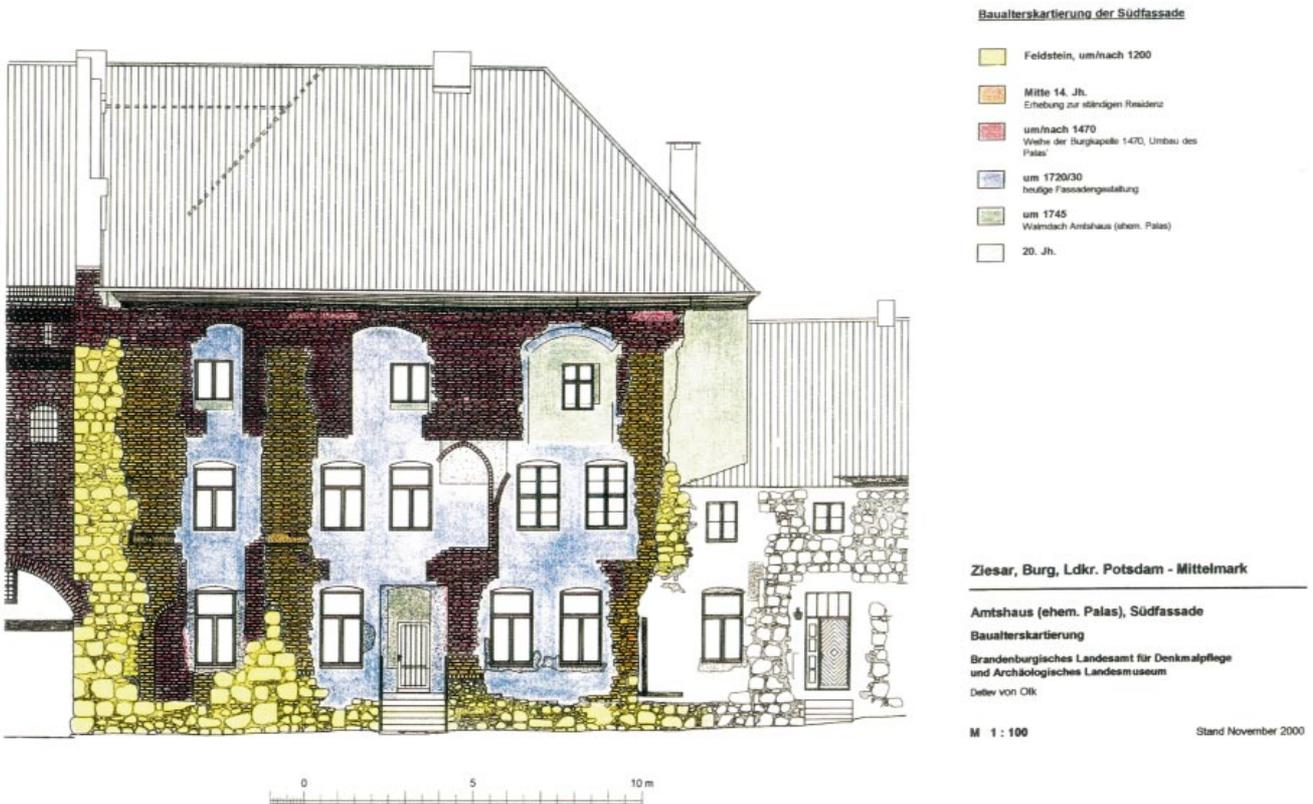
Abb. 8 Baualtersplan einer Fassade: Zusammenfassung der bauhistorischen und restauratorischen Untersuchungen in Vorbereitung der Sanierung, Zeichnung auf der Grundlage eines entzerrten Messbildes im Maßstab 1:50
