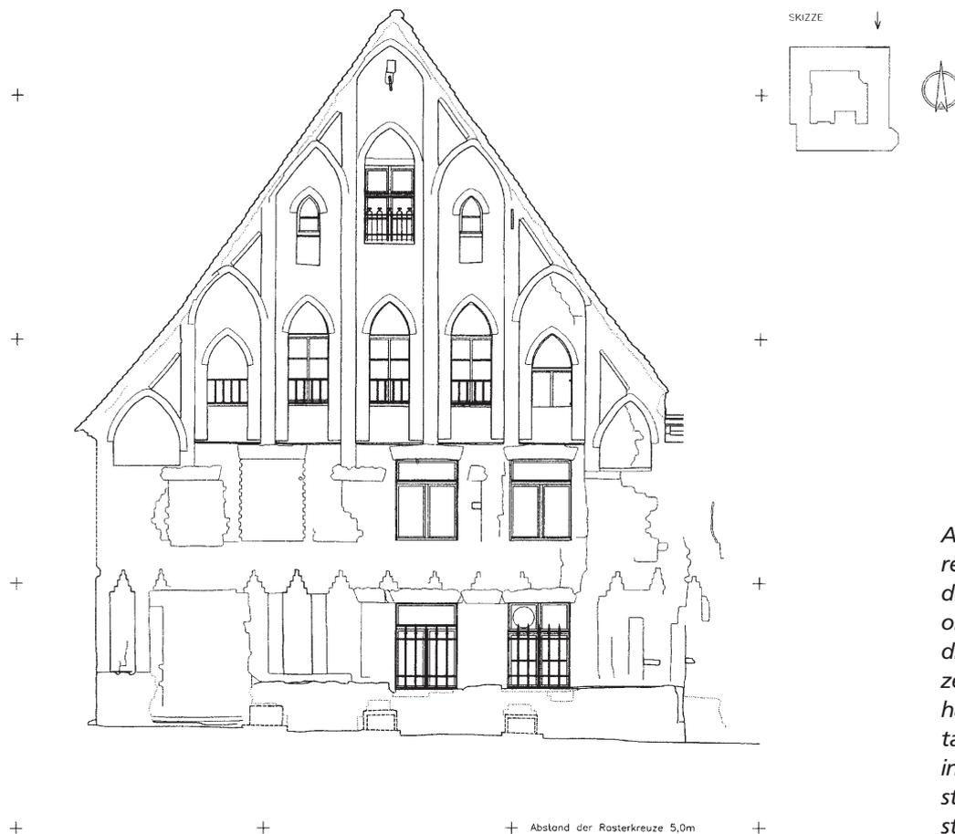
Abb. 5b Nicht steingerechte Stereoauswertung des gleichen Objekts wie oben, die an Informationsdichte gegenüber dem entzerrten Messbild verloren hat, schon eine Interpretation darstellt, aber eine in allen Bereichen maßstäbliche Zeichnung darstellt
