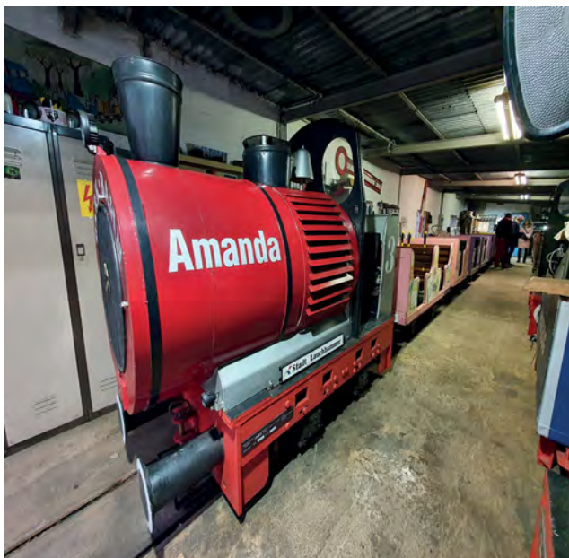
37 Lauchhammer, Schmalspur-Diesellok „Amanda“, Typ Ns1, Fabriknr. 47012, Baujahr 1952. Foto: Louise Warnow, BLDAM, 2022
